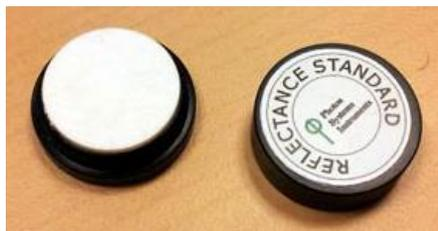
Fig. 3 Reflectance standard Spectralon.
